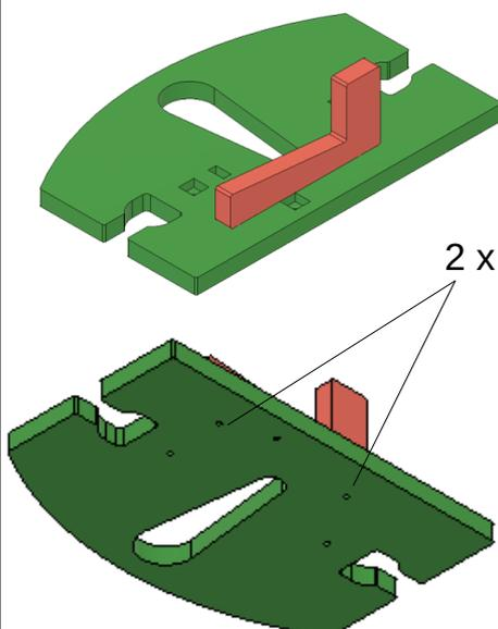
5. Die Verbinder mit der schmaleren Tasche nach innen in den Fuss eindrücken. Dann den Mittelteil von oben einstecken und das Ganze im Anschluss von unten verschrauben.
