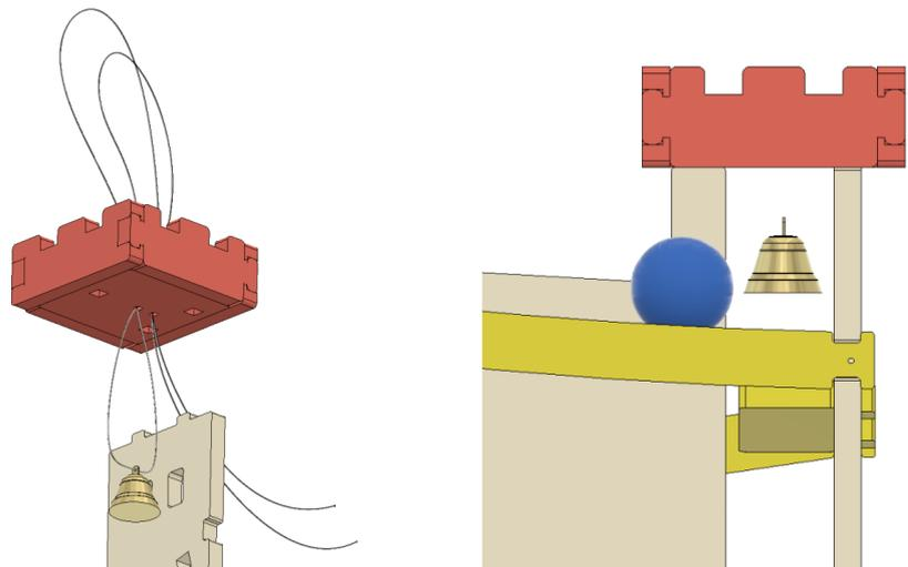
9. Zinne von oben verschrauben. Und den überschüssigen Faden abschneiden.
