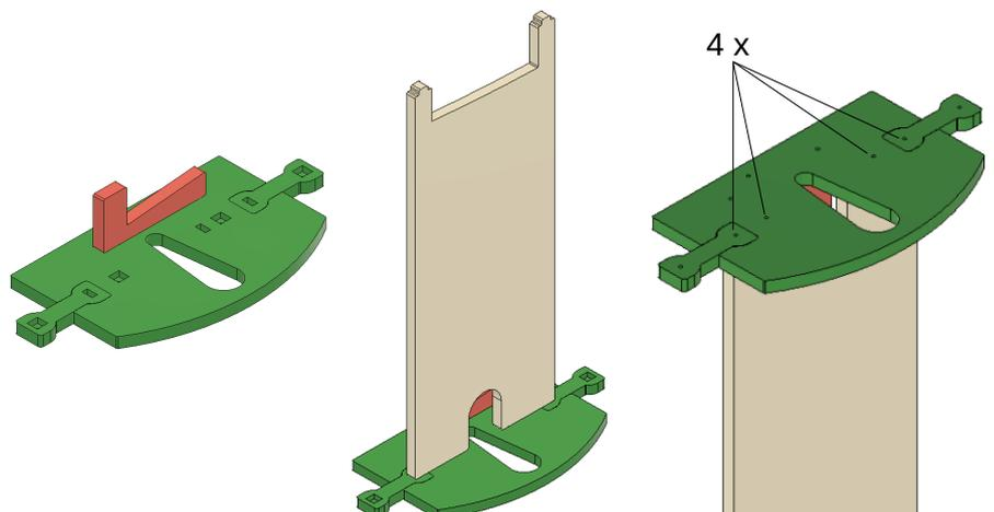
6. Außenteile des Fusses aufstecken. Dann die Seitenteile mit den Schienen von oben aufstecken. Im Anschluss von unten verschrauben.
