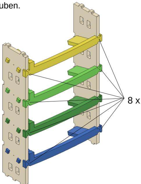
3. Hintere Schienen mit den Seitenteilen verschrauben.
