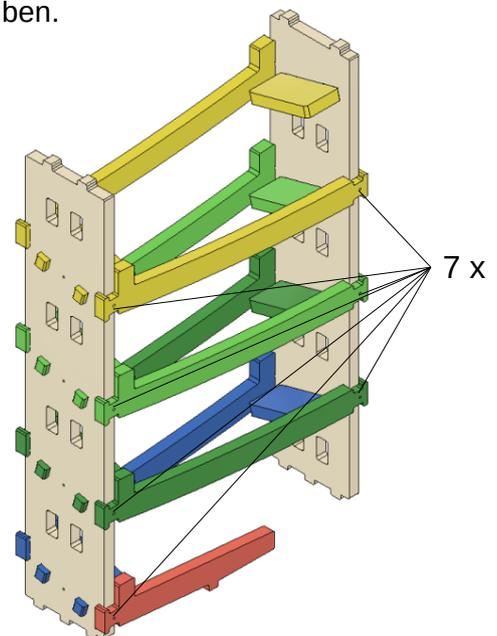
4. Auswurf in Fussteil stecken und von unten verschrauben.
