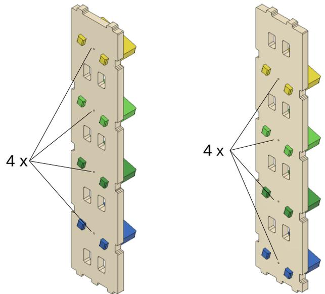
2. Vordere Schienen mit den Seitenteilen verschrauben.
