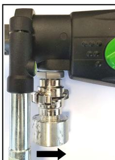
Beim Arbeiten entstehender Staub ist gesundheitsschädlich. Bei Trockenbohrungen ist deshalb ein Staubsauger zu verwenden und eine Staubschutzmaske zu tragen. Setzen Sie den Adapter für die Staubabsaugung auf den Anschluss der Maschine und drehen Sie ihn in Pfeilrichtung gegen den Anschlag.
