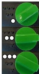
PLD 182.1 NT har en 3-trins oliebads gearkasse. Juster hastigheden efter borets diameter.
