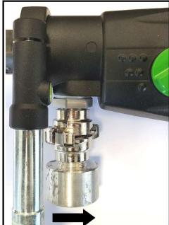
Støv der opstår under kerneboring er sundhedsskadeligt. Derfor skal der anvendes støvsuger, samt bæres støvmaske ved tørboring. Anbring adapteren til støvudsugning på maskinens tilslutning, og drej den i pilens retning for fastlåsning. Våd/tørstøvsugeren DSS 35 M iP, kan anbefales som tilbehør. Anvendelsen af støvsuger under tørboring, er også påkrævet for optimal ydelse for diamantkerneboret (Luftkøling).
