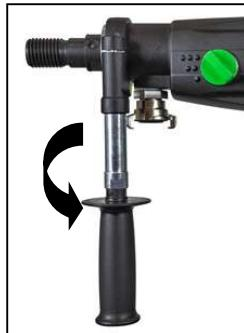
Bij handmatig gebruik mag de boor alleen worden gebruikt in combinatie met de bijgevoegde losse handgreep. Deze wordt aangebracht op de spanhals en bevestigd door de greep aan te draaien.
