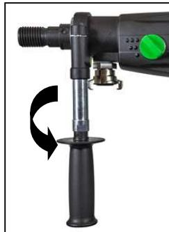
Pour une utilisation manuelle, il est nécessaire d'utiliser la seconde poignée; celle-ci doit être solidement fixée sur le collet.
