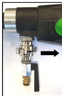
Placez l'adaptateur avec la valve à bille sur le connecteur de l'outil et tournez dans le sens de la flèche jusqu'à l'arrêt. Branchez l'outil au réseau d'eau ou à un réservoir sous pression en utilisant le mamelon bien ajusté.
