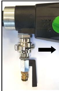
Setzen Sie den Adapter mit dem Kugelhahn auf den Anschluss der Maschine auf und drehen Sie ihn in Pfeilrichtung gegen den Anschlag. Schließen Sie die Maschine über das Stecknippel an die Wasserversorgung oder ein Wasserdruckgefäß an.
