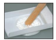
2. Mit feuchtem Spachtel die Flocken gut aufrühren. Die Flocken fühlen sich weiterhin trocken an.
