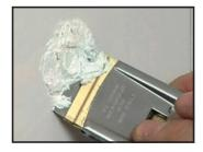
3. Der Kleber kann mit einem Glasschaber und/ oder Silikonentferner rückstandslos entfernt werden.
