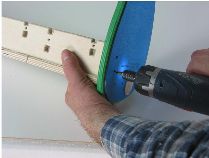
von unten mit den schwarzen  $\varnothing 3 \times 20$  mm Schrauben verschrauben
