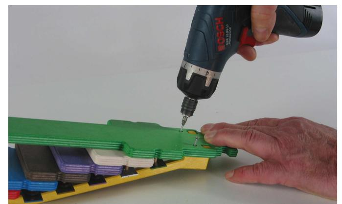
von unten mit 2 silbernen  $\varnothing 2,5 \times 20$  mm Schrauben verschrauben
