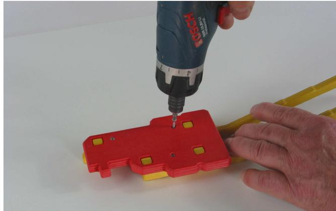
von unten mit 3 silbernen  $\varnothing 2,5 \times 20$  mm Schrauben verschrauben
