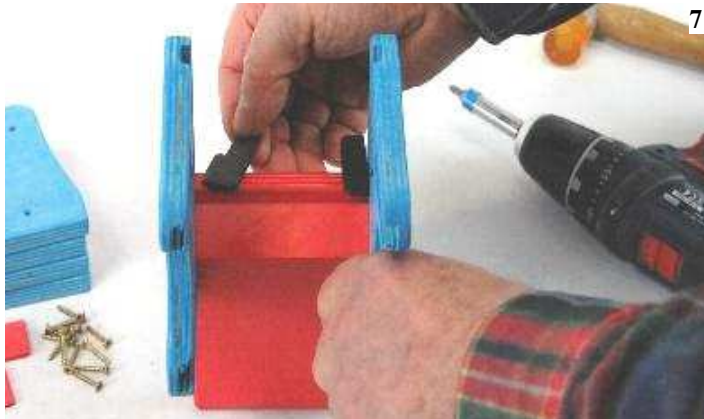
die beiden braunen Distanzplättchen entfernen
