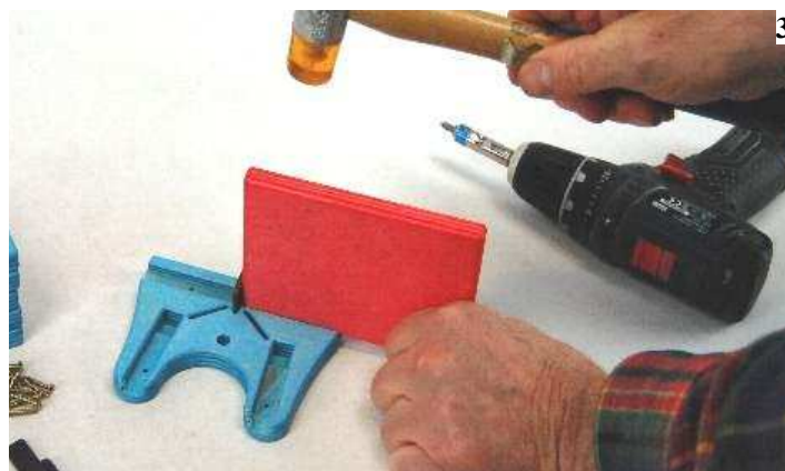
ein rotes Rückteil in den Nut an das Positionierplättchen stecken.
