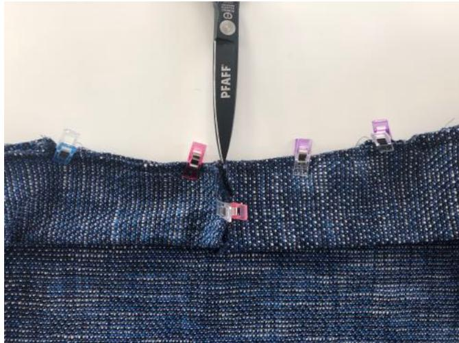
Nehme alle Klammern wieder ab, klappe den Kragen auf, lege die kurzen Enden rechts auf rechts und nähe an der Stelle der Knipse den Kragen zusammen.
