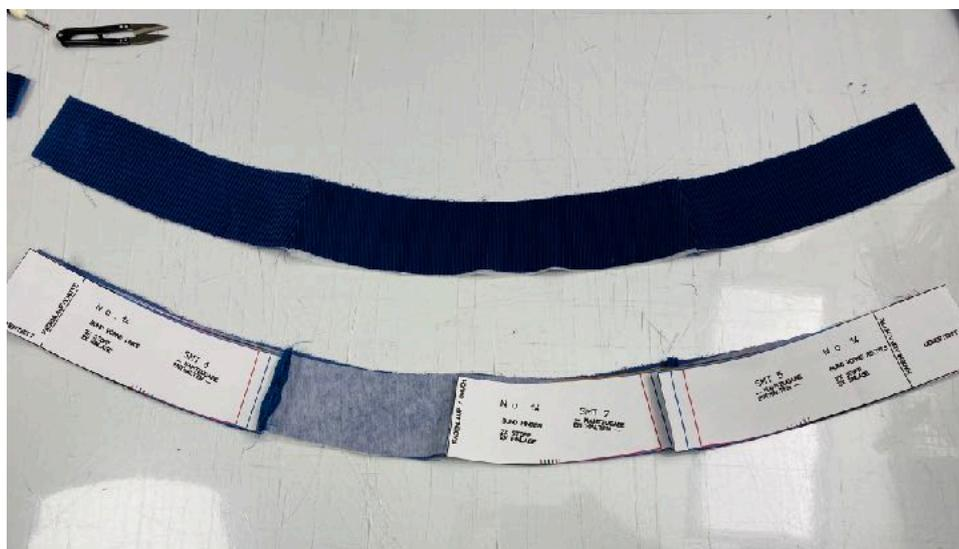
Diese beiden Bundteile nun rechts auf rechts aufeinander legen und an der kürzeren langen Seite mit der Nahtzugabe von 1 cm zusammen steppen. Danach die Nahtzugabe knapp kantig am späteren inneren Bundbeleg fest steppen.
