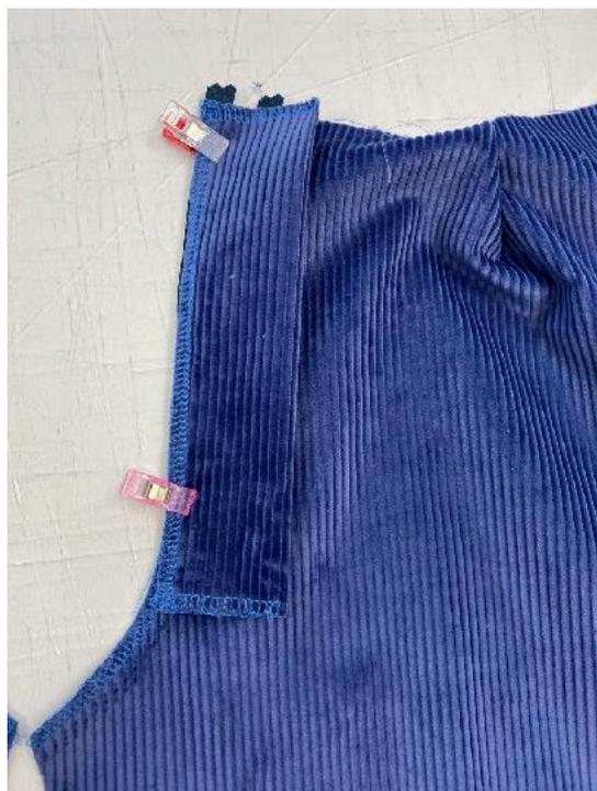
Danach kann der Untertritt aufgeklappt werden und der Reißverschluss wird knappkantig abgesteppt, damit man nicht später immer den Stoff in der Hose einklemmt beim öffnen.
